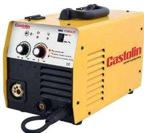
Poste ultra-compact multi procédés avec fonction soudage à l'électrode enrobée (pince fournie). Livré avec touche MIG EURO, galets acier/fil fourré/alu, câble de masse et câble porte électrode.
